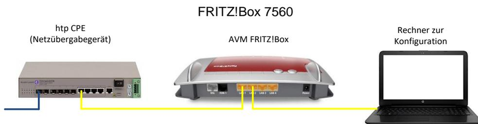
2. Verbinden Sie mit dem beiliegenden RJ-45 Netzwerkkabel die Schnittstelle „LAN1“ der FRITZ!Box mit der ersten (linken) RJ-45 Schnittstelle der htp CPE (Netzübergabegerät).
